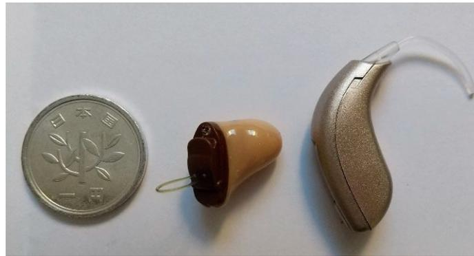
補聴器がデジタル化したことは、小型化だけでなく、機能にも大きな進化をもたらしました。難聴になると小さい音が聞こえなくなるだけでなく、音を聞き分ける力が低下したり、大きな音に対する不快感が増えたりすることが多くあります。そのため補聴器には単純な増幅機能だけでなく、音に対する不快感を低減させ音声を聞き取りやすくする機能が開発されました。「小さな音の増幅は十分に行い、大きな音の増幅は適度に抑える機能（ノンリニア増幅）」、「雑音抑圧機能」、「指向性機能」などは、現在ではほとんどの補聴器に搭載されるようになりました。また、無線通信機能やスマートフォンとの連携機能などを搭載している補聴器もあり、テレビや携帯電話の音を直接補聴器で聞くことができます。
