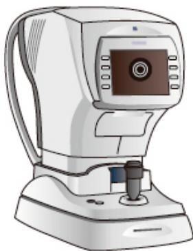
「オートレフケラトメータ」を覗くと、正面に絵が現れ、最初はピントが合った状態になっており、すぐにぼやけます。これを「雲霧」と言うのですが、このぼやけた瞬間に眼がリラックスするため、その瞬間を逃さず眼の屈折力を測定します。眼には見えない赤外光を網膜に当てて、反射した光から割り出します。その間、わずか数秒です。その測定結果を元にめがね（眼鏡）やコンタクトレンズが処方されるのです。以前は手で瞳孔に合わせていたりしていたが、今では台にあごを載せて機器を覗き込むだけで自動的に瞳孔に合わせて測定を始めてくれます。どこの眼科にも置かれている機器です。
